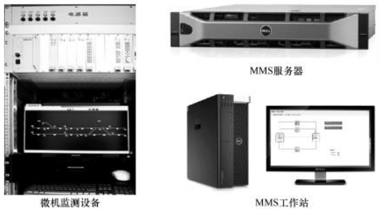
图 10-14 MMS 子系统设备
