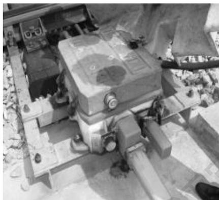
图 5-11 开——打开盖孔板及钩锁器
