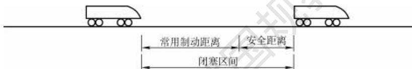
图 2-4 移动闭塞线路闭塞分区划分
